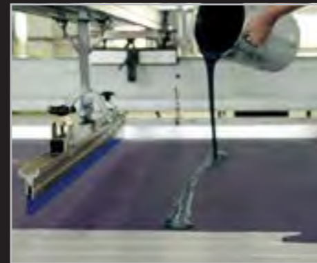
Keramische zeefdruk-inkt bevat vermalen glasstukjes en pigmenten. De monokleur wordt op de zeef aangebracht.
