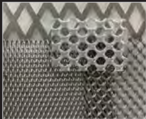
Geperforeerd stekmetaal | gaas
