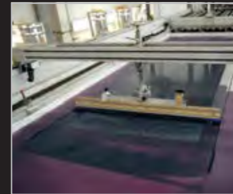
De inkt wordt nu door de zeefgaatjes gedrukt op het glasopper-vlak. Dit proces herhaalt zich met elke kleur.
