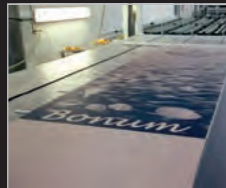
Na droging is het glas is gereed om de oven in te gaan. Het glas wordt verhit tot 620°C.
